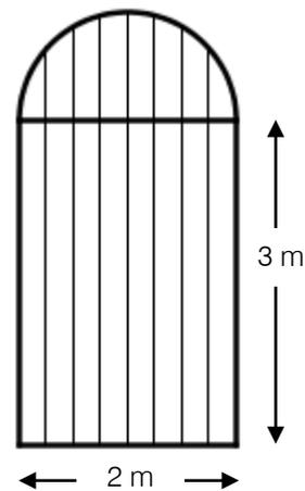
En el eje horizontal se nombró la coordenada que corresponde a cada una de las barras; sólo se necesita calcular las alturas de las barras correspondientes a  $x_2$ ,  $x_3$  y  $x_4$ , puesto que  $x_1$  tiene longitud 1 m por ser el radio de la semicircunferencia, y además  $x_5$ ,  $x_6$  y  $x_7$  por simetría serían igual a  $x_2$ ,  $x_3$  y  $x_4$ .
