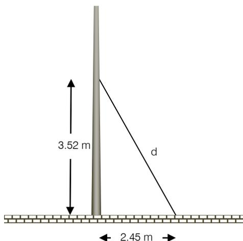
Como se observa en la figura, se forma un triángulo rectángulo, por lo cual se puede aplicar el Teorema de Pitágoras para encontrar la longitud (d) del tirante.
