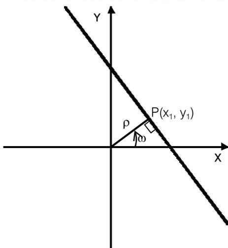
La recta que se observa se conoce como *la recta normal*, ésta es perpendicular al segmento que está anclado en el origen y que la toca en el punto  $P(x_1, y_1)$ , dicho segmento tiene longitud  $\rho$  y ángulo de inclinación  $\omega$ .
