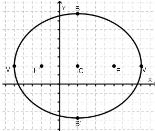
En la gráfica se observa que la longitud del semieje mayor es 7, y el semieje focal es 4, con centro en el punto  $C(2, 2)$ ; el semieje menor no se puede calcular con exactitud en la gráfica, es necesario hacerlo por medio del Teorema de Pitágoras.
